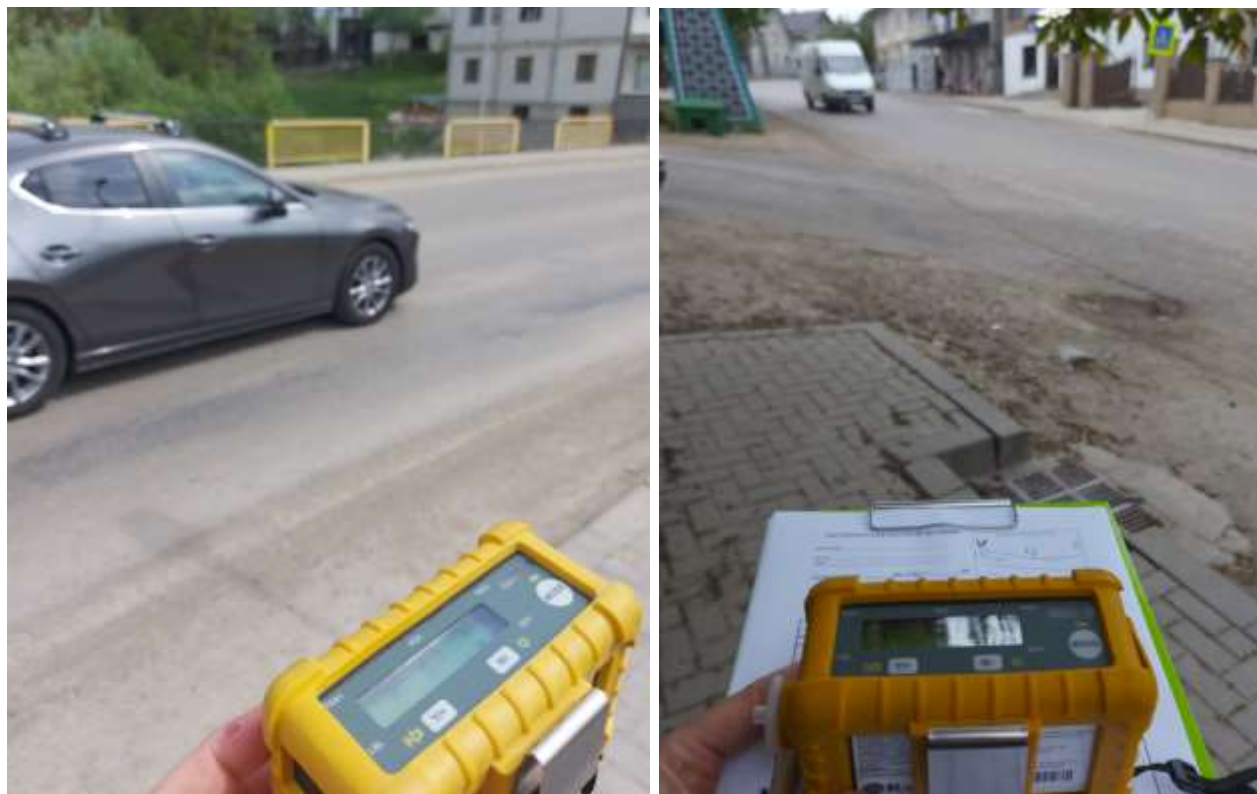
Figura 73 – Măsurarea emisiilor produse de traficul rutier cu Analizorul MultiRAE IR
