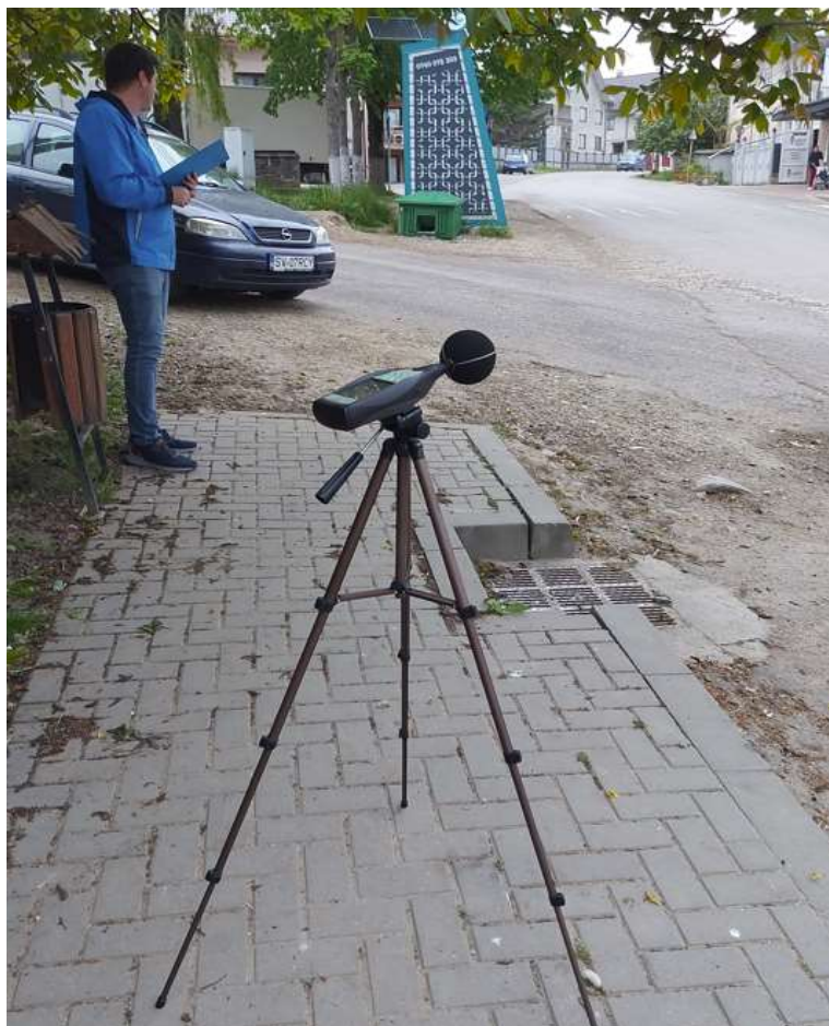
Figura 75 - Măsurarea poluării sonore produse de traficul rutier cu Sonometrul Bruel&Kjaer model 2250
